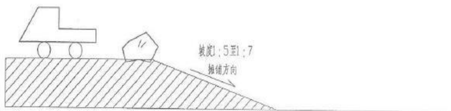
图 3-3-4 煤矸石摊铺作业方法示意图
