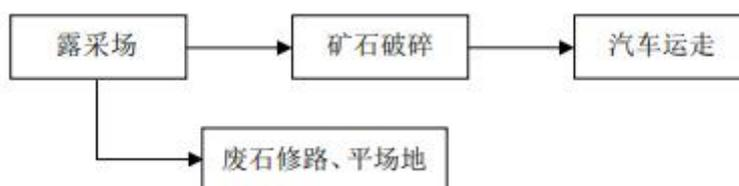
图 4-1 项目区损毁土地工艺流程
